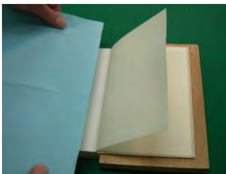
⑮乾燥したら表紙を開き、本文紙の最初のページののど部分を 5mm 程残して捨て紙をかぶせる。
