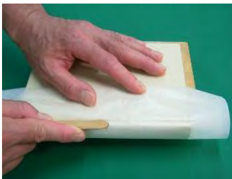
⑬溝の部分にはへらを使い、貼り残しができないようにしっかり圧着させる。
