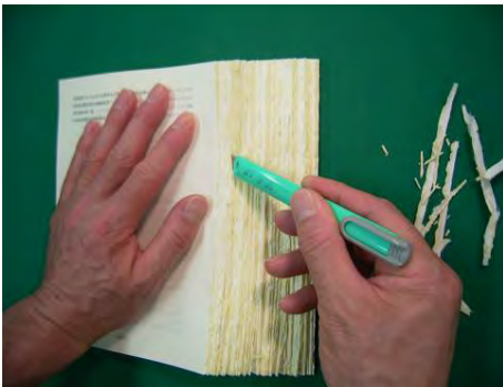
⑤背に残っている接着剤をカッターナイフの刃の折り口を使い丁寧に落とす。このとき中身を傷つけないようにする。
