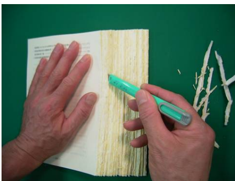
⑤背に残っている接着剤をカッターナイフの刃の折り目を使い丁寧に落とす。このとき中身を傷つけないようにする。
