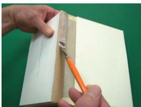
⑨筒がしっかりと背に貼りついたことを確認して、筒の上にボンド糊を塗る。
